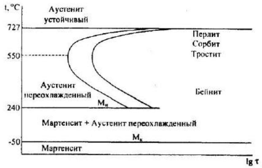
Рис. 20. Диаграмма изотермического превращения аустенита эвтектоидной стали
